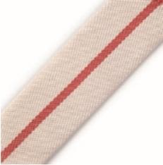
**JET:** Manichetta composta da un tessuto circolare ad armatura diagonale di poliestere ad alta tenacità internamente impermeabilizzata con tubolare prevulcanizzato. Perfettamente ancorato alla calza tessile. L'alta resistenza all'usura la rendono ideale per chiunque voglia un prodotto di elevata affidabilità. Omologata ENI 0198.00 Tipo A.
