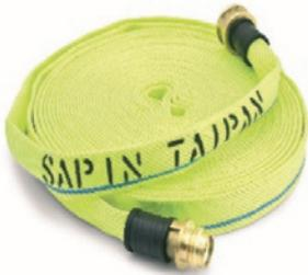
**JET TAIPAN:** Manichetta alta pressione con rapporto della costruzione tessile maggiorato all'esterno per garantire una maggior resistenza all'abrasione. Ottimo raggio di curvatura. Pressione di esercizio 40 bar – pressione di scoppio > 100 bar.
