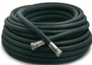
**PYTON BOOSTER:** Tubazione semirigida ad alta pressione conforme alla norma UNI EN 1947- Cat. II, Type B, Class 3 ideale per pompe e camion antincendio. Composta da una calza tessile con trama di monofilo. Il sottostrato impermeabilizzante in EPDM è particolarmente indicato per ridurre al minimo le perdite di carico ed è altamente resistente all'invecchiamento ed all'ozono. Spalmatura esterna ulteriore di colore nero.
