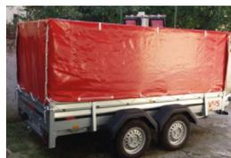
**CENTINA DI COPERTURA TELONATA.** Struttura portante in tubolare di acciaio verniciato. Rivestimento con robusto materiale plastico impermeabile PE/PVC uso esterno garantito per robustezza e resistenza nel tempo, unito tramite cuciture termosaldate. Colorazione rosso, bianco, grigio, altra su richiesta. Completo di occhielli per il fissaggio e apertura/chiusura munite di cinghie arrotolatrici. Altezza utile (m) 1,50 (altra su specifica richiesta)
