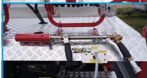
VAS0003120 Lancia erogatrice tipo mitra EXPANSION FOAM. (ugello uscita 3) completa di innesto rapido. **(in sostituzione alla lancia idrica)**
