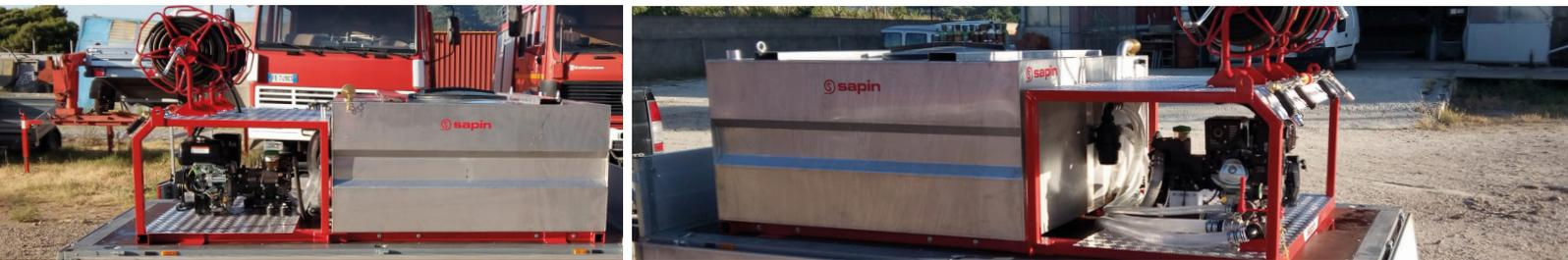
**2** **COMPONENTE LONGHERONI IN TUBOLARE E TRAVERSE PER IRRIGIDIRE LA STRUTTURA.**
